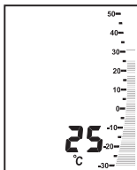
Affichage des mesures des températures minimums et maximums à l'aide de traits clignotants sur le bargraph
