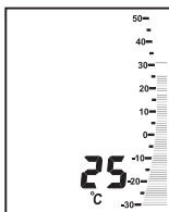
Visualización de las mediciones de las temperaturas mínimas y máximas mediante los guiones intermitentes del gráfico de barras.
