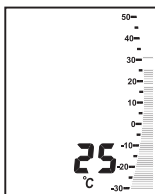
Visualizzazione delle misurazioni delle temperature minima e massima con tratti intermittenti sul grafico a barre
