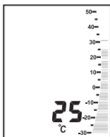
Anzeige der Mindest- und Höchsttemperaturmesswerte anhand der blinkenden Striche auf dem Balkendiagramm
